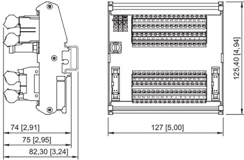
Placa de conexiones HART, tipo 9196/16H-XX0-05c
