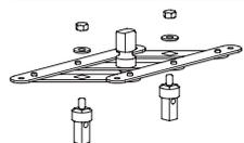
Para el accionamiento simultáneo de 2 interruptores de carga y motor combinados entre sí
