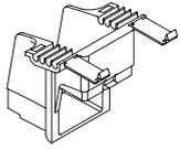
Para garantizar la medida necesaria del hilo (50 mm) entre los puntos de conexión de circuitos eléctricos de seguridad intrínseca y sin seguridad intrínseca
