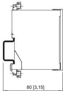
Montado en raíl de montaje DIN NS 35/15
