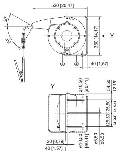
Pinza de puesta a tierra con enrollador automático de cable
