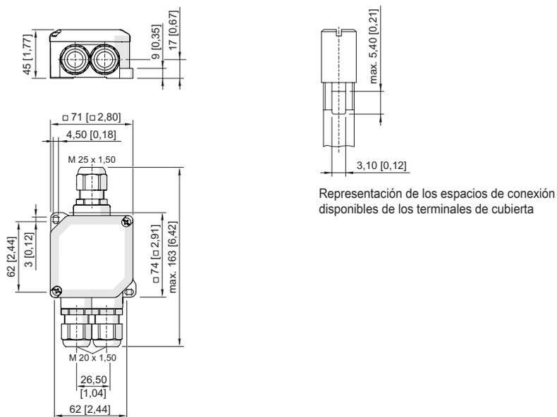
con entradas de cable 2 x M20, 1 x M25
