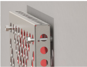
Tenir le chauffage près de la surface de montage et insérer les vis M6 dans chacun des quatre trous de montage.
