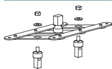
pour l'actionnement simultané de 2 interrupteurs de puissance/moteur combinés entre eux
