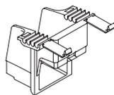
pour assurer le respect de l'écart de 50 mm requis entre les points de raccordement des circuits de sécurité intrinsèque et de sécurité non intrinsèque
