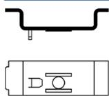
L'adaptateur permet l'installation d'une barrière de sécurité sur la base de bride (N° d'art. 165283) ou une plaque de montage d'une série précédente.
