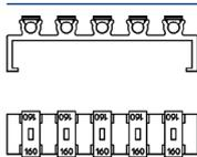
Le porte-fusible se clipse sur le côté de la barrière de sécurité et peut héberger jusqu'à 5 pré-fusibles (remplacement).
