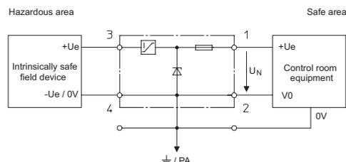
Barrières Zener de sécurité intrinsèque un canal avec limitation électronique de courant pour potentiel positif
