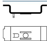
L'adaptateur permet l'installation d'une barrière de sécurité sur la base de bride (N° d'art. 165283) ou une plaque de montage d'une série précédente.
