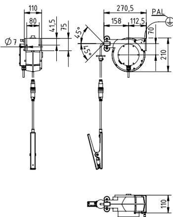
Erdungszange mit Kabel-Aufrollautomatik
