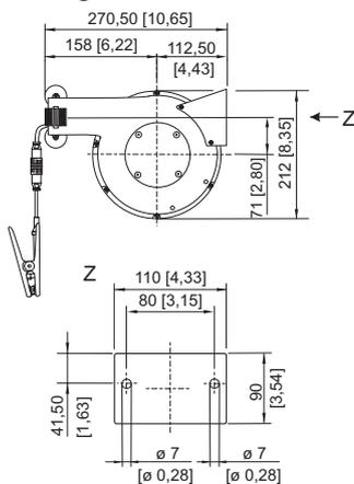
Erdungszange mit Kabel-Aufrollautomatik
