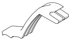
Die Fallsicherung für die Leuchtenabdeckung verhindert das versehentliche Herunterfallen der Leuchtenabdeckung nach Öffnen der Leuchte.
