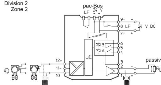
Feldgerät                      ISpac Trennstufe                      SPS / PLS
