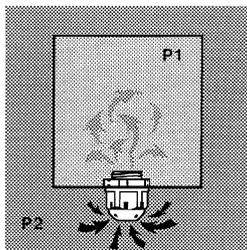
Temperaturbedingte Druckdifferenzen zwischen Gehäuseinnenraum (P1) und der umgebenden Atmosphäre (P2) werden über den Klimastutzen sicher ausgeglichen. Dadurch wird die Kondenswasserbildung im Gehäuse auf ein Minimum begrenzt.
